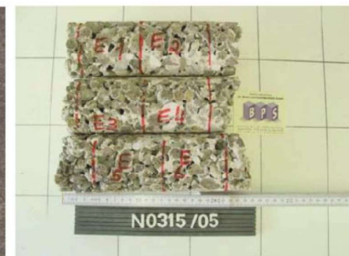
Prüfkörper der Kernbohrungen
