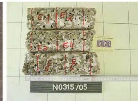
Prüfkörper der Kernbohrungen
