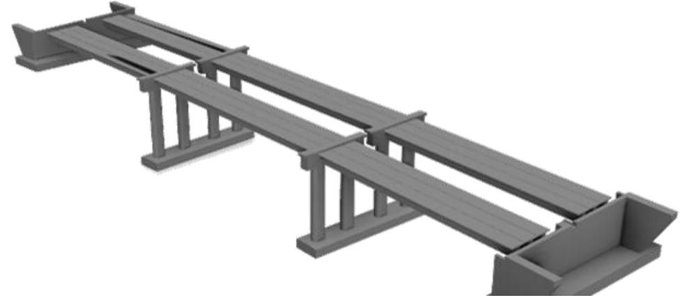
Betonfertigteile, Widerlager / Unterbau
